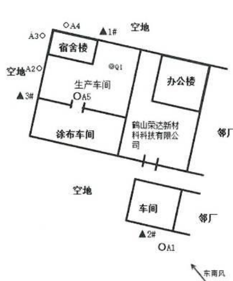
图 7.1 有组织废气、无组织废气及噪声检测点位示意图 (●表示有组织废气检测点位、○表示无组织废气检测点位、▲表示噪声检测点位)
