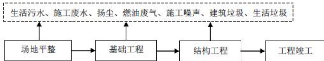
图4-1 建筑施工流程图
