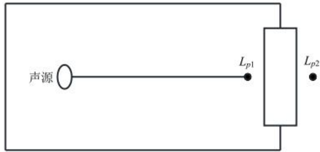
图 4-3 室内声源等效为室外声源图例
