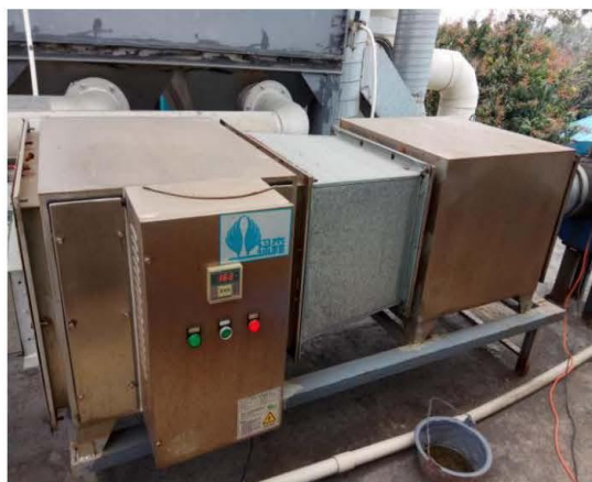
图33：热固化废气处理装置
